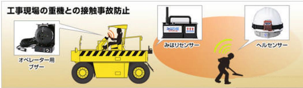
重機に取り付けた発信装置と作業員装着の受信装置で、危険エリアに作業員が入ると作業員と運転席の双方に警報を発する双方向式の警報補助装置です。
